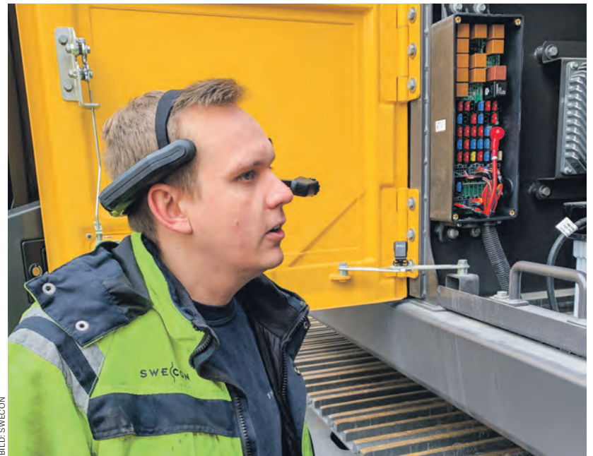
En lösning som testas av Swecon är en handsfree-lösning med inbyggd kamera, skärm och mikrofon som kan användas vid reparationer och underhållsarbeten.
